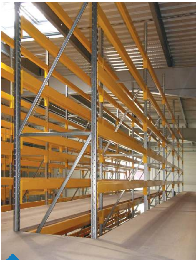
Runkoihin kiinnitetty kulkuteillä varustettu taso, korkeus 5400 mm.
