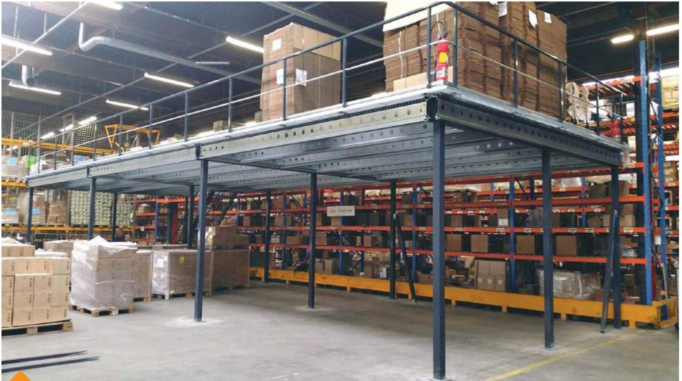
Itsekantava tasorakenne – tilaa säästävä ratkaisu.
