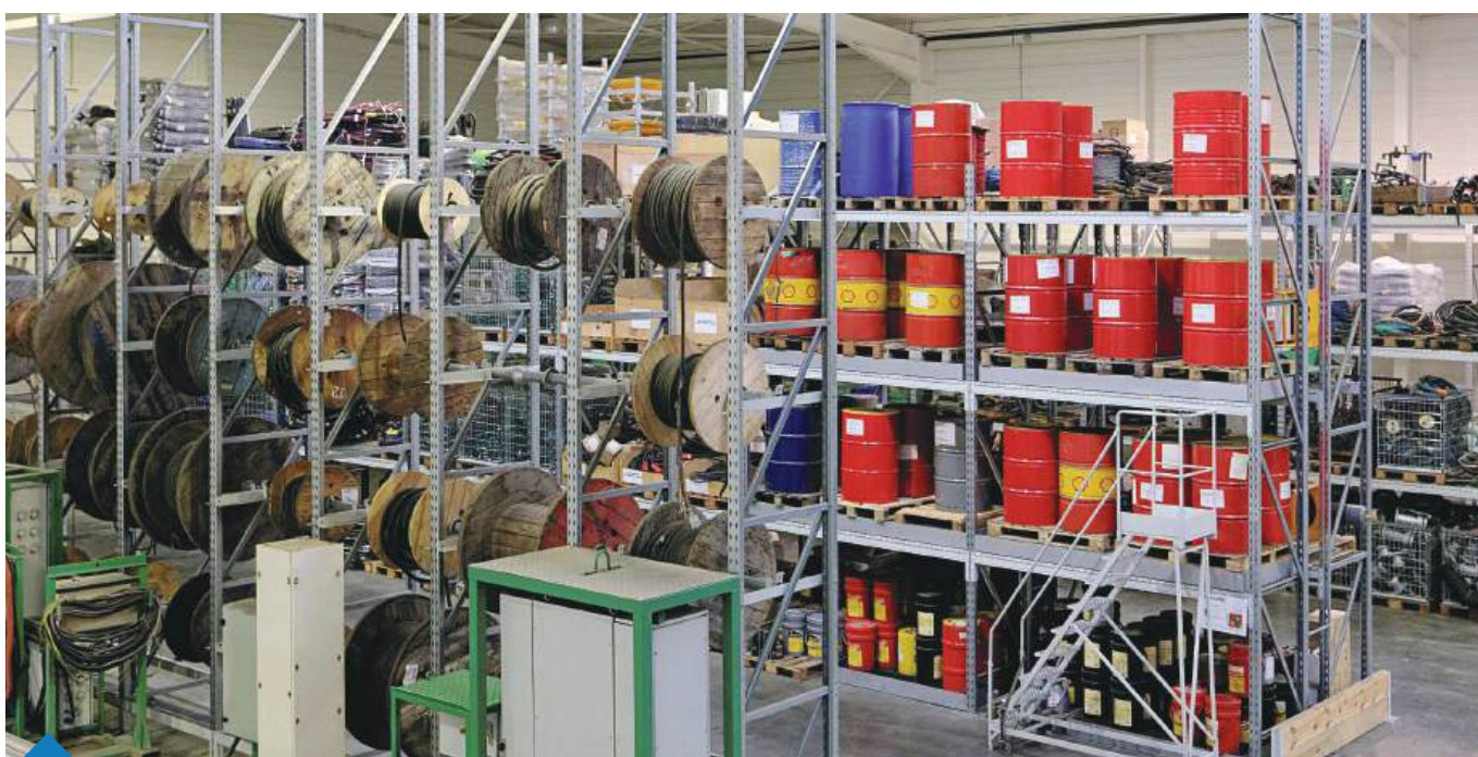
Kelojen ja kemikaalien varastointi valuma-altailla varustetuissa kuormalavahyllyissä.
