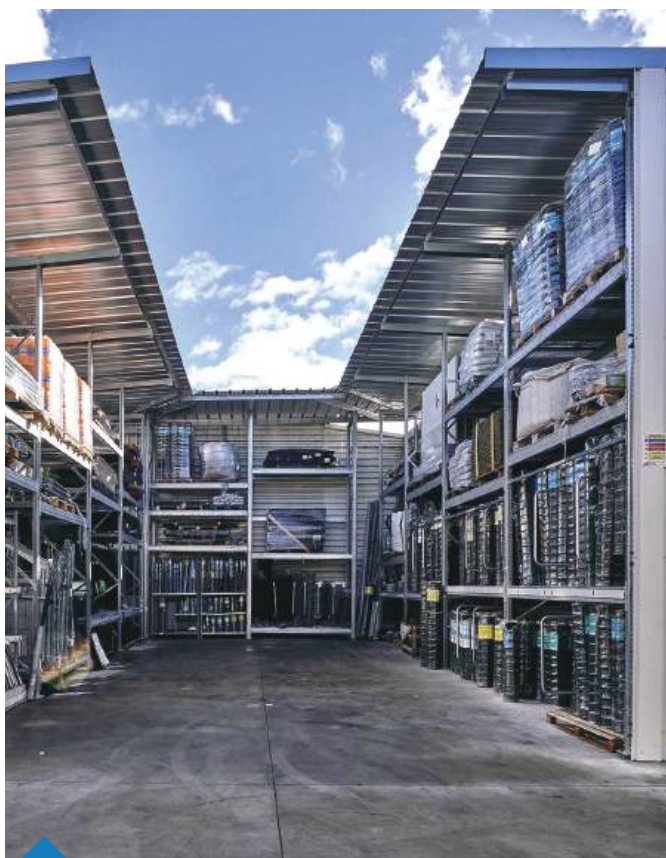
Materiaalipiha: PROPAL 3 katolla sekä taka- ja sivuverhouksilla tuotteiden suojaamiseksi.
